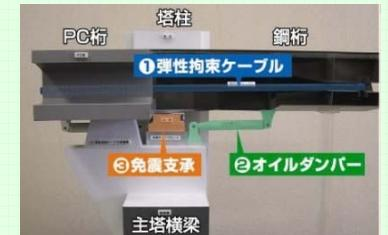
主塔に設置されている制振装置
